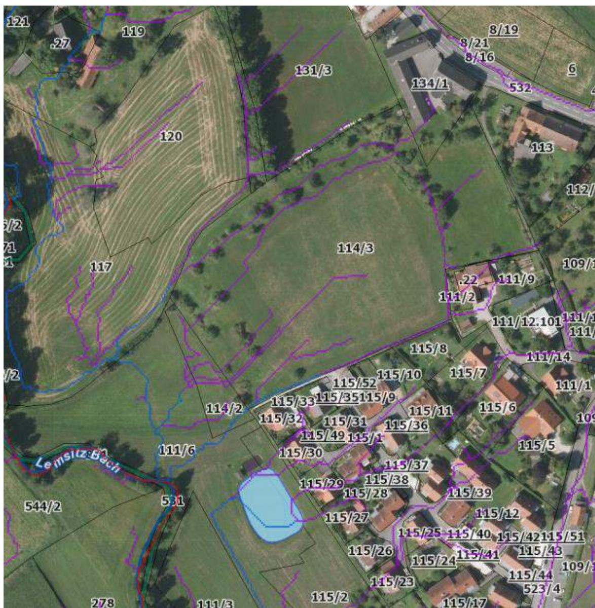
Abbildung 1: Fließpfade des Oberflächenabflusses im Projektgebiet
